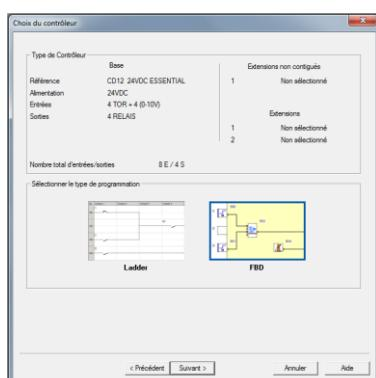
☛ Sélectionner le type de programmation : **FDB** (Functional Block Diagram).
