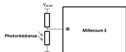
Pour le détecteur de seuil de luminosité, la tension présente sur l'entrée IB du Millenium est fonction de la valeur de la luminosité du capteur (photodiode).
