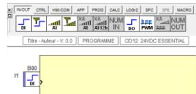
Cliquer droit sur la borne d'entrée choisie, dans le menu choisir la fenêtre de paramétrage et sélectionner le bouton poussoir.
