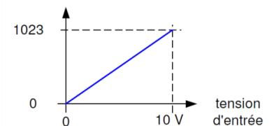
Le contrôleur va effectuer une conversion de cette tension pour la transformer en une valeur numérique comprise entre 0 et 1023 (conversion analogique sur 10 bits).
