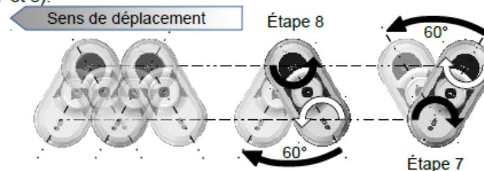
Il est possible de choisir le premier mouvement que le robot va exécuter, par exemple après l'appui sur la touche « droite » de la télécommande, le robot commence le balayage de la paroi vitrée par un déplacement horizontal vers la droite.
