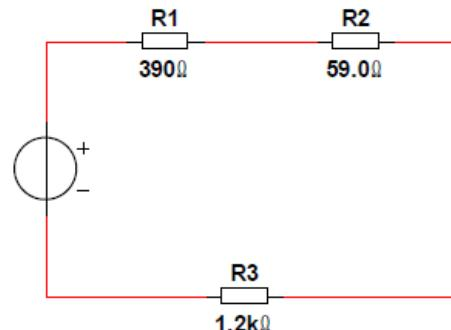
La résistance équivalente ( $R_{EQ}$ ) du montage est de  $1\,649\,\Omega$  :
