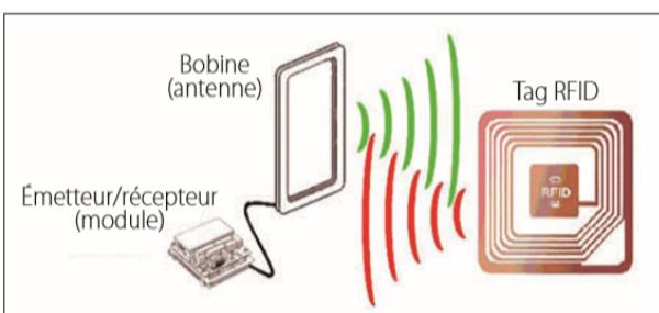
Le lecteur envoie des requêtes aux tags RFID pour récupérer des données stockées dans leur mémoire. Le tag, généralement télémétriquement alimenté par le signal du lecteur, génère en premier lieu un code permettant d'identifier l'objet sur lequel il est déposé. La communication entre les deux entités s'engage. Le lecteur peut procéder à une écriture d'information dans le tag.
