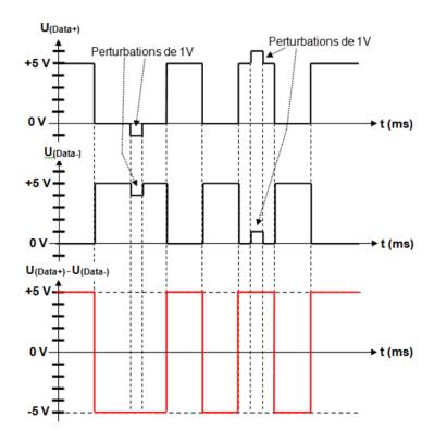
**Q2**: À partir du chronogramme obtenu et du document technique DT1, **conclure** sur l'intérêt d'utiliser une transmission symétrique.
