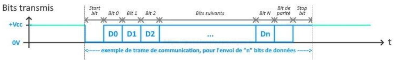
Figure 2 : trame d'une transmission série UART
