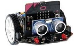
Figure 7 : capteur à ultrasons
