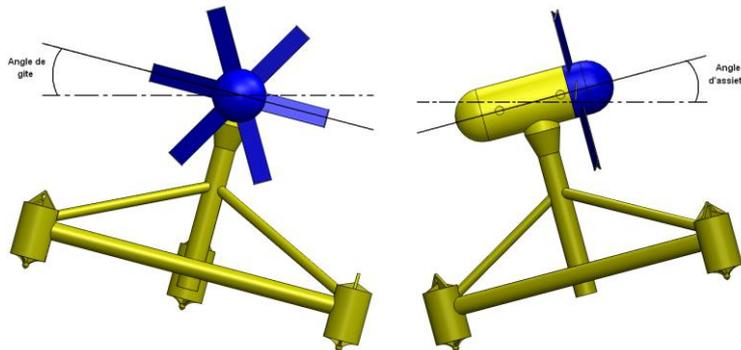
Le défaut de positionnement peut apparaître au moment du posage de l'hydrolienne sur le fond marin mais aussi en cours d'exploitation. En effet, l'hydrolienne peut se déplacer sous l'action de courants marins exceptionnellement forts. Afin de surveiller son inclinaison, un inclinomètre est installé à l'intérieur de l'hydrolienne.
