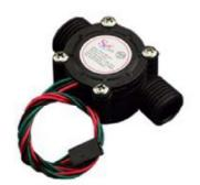
Le capteur de débit est constitué d'un rotor et d'un capteur à effet hall. Lorsque le liquide passe dans le capteur, le rotor génère des impulsions en fonction du débit. La fréquence de sortie varie en fonction de la vitesse du rotor. En connaissant le diamètre du tuyau, il est possible de calculer la vitesse du liquide.
