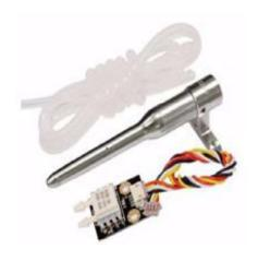
La sonde Pitot a été inventée par Henri Pitot en 1732. Ce tube de Pitot permet la détermination de la vitesse d'un fluide grâce à la mesure d'une différence de pression entre la pression statique Ps et la pression totale Pt. La vitesse du fluide est directement liée à cette différence de pression.
