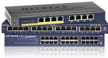
Relier deux ordinateurs peut avoir un intérêt, mais dans la plupart des cas, un réseau sera constitué d'un plus grand nombre d'ordinateurs. Dans ce cas, il est nécessaire d'utiliser une commutateur réseau switch en anglais). Un switch est constitué de plusieurs prises RJ45.
